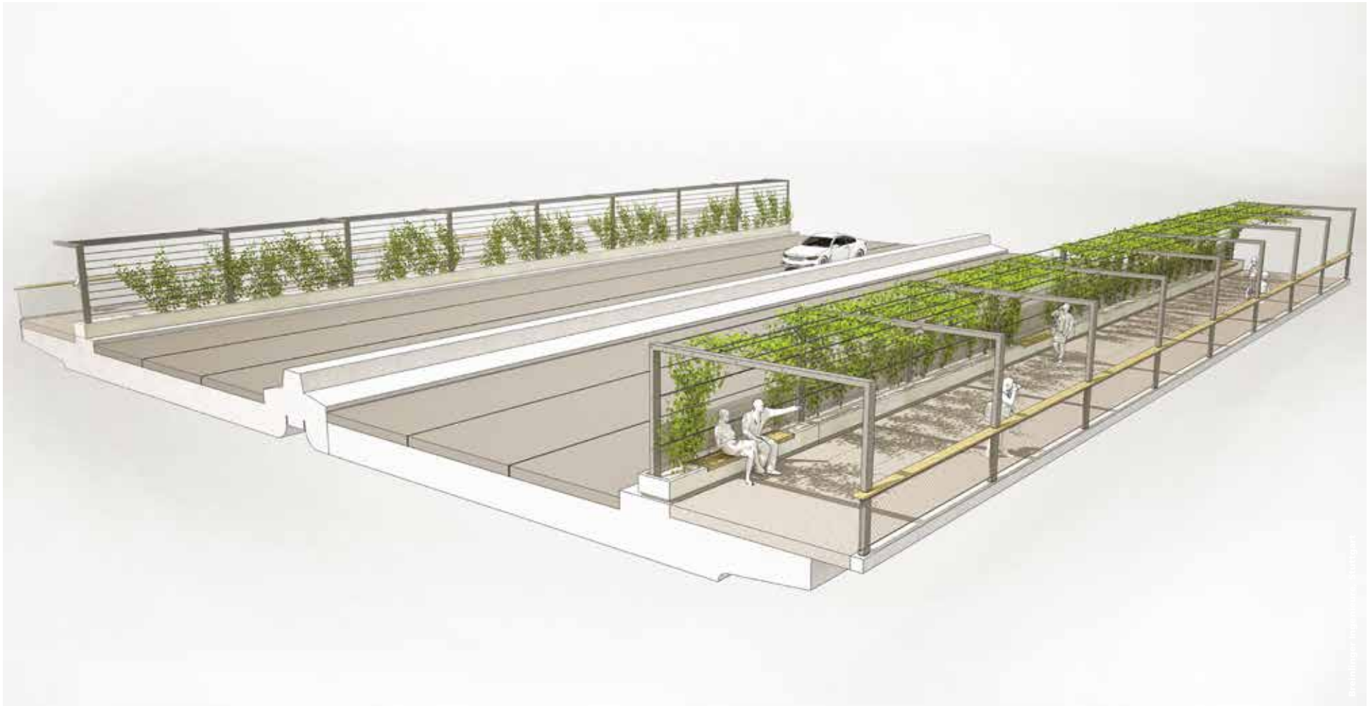
Straßenquerschnitt B10 / Wallstraßenbrücke mit Glacissteig
