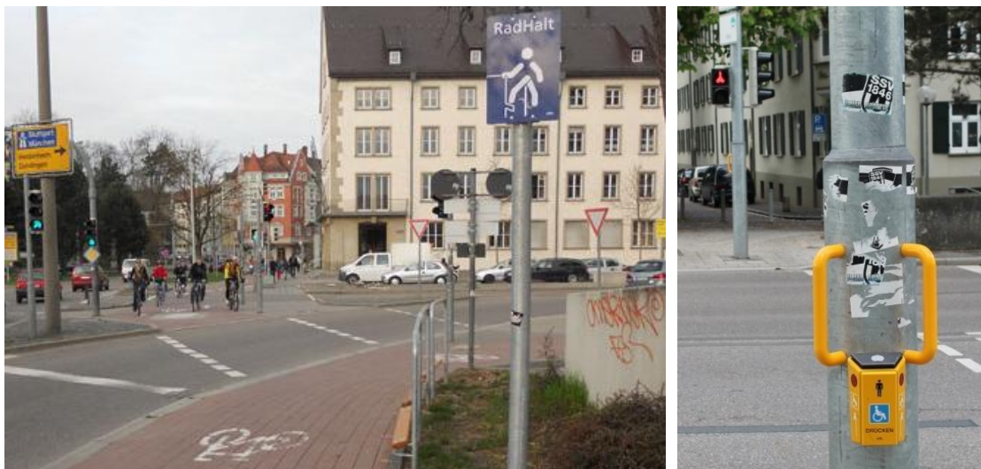
Abb. 46: „RadHalt Ulm“ mit Trittbrettern und mit Haltegriff [Bild: Stadt Ulm]
